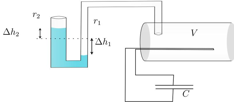
Abbildung 1: Schema eines Manometers
