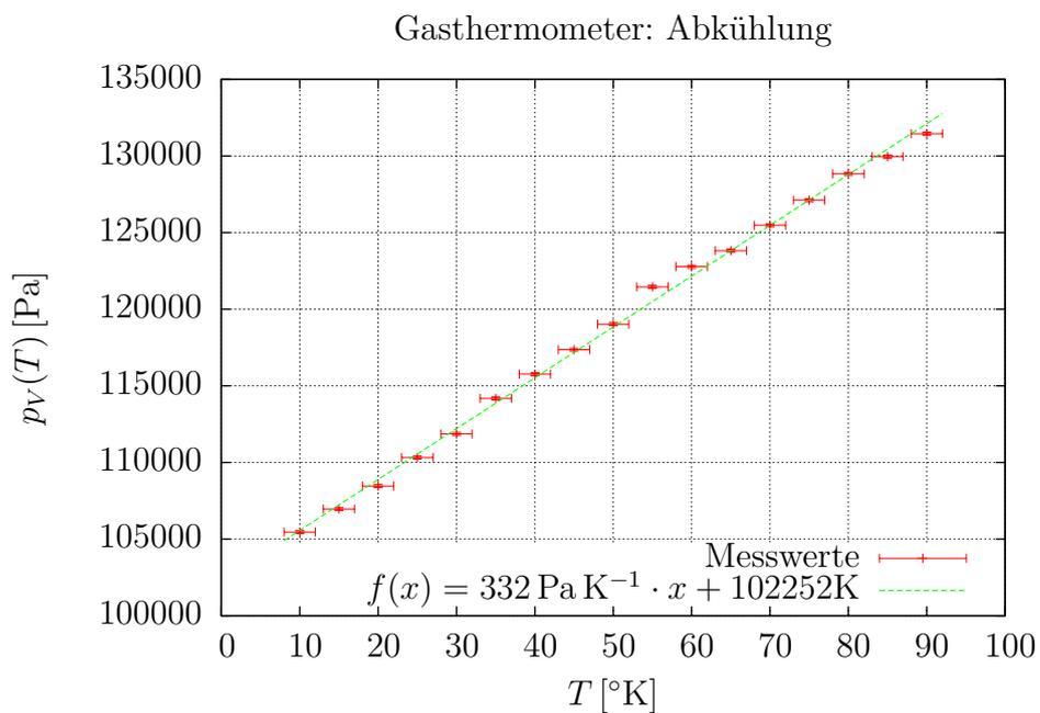
Abbildung 5: Druckmessung während Abkühlung
