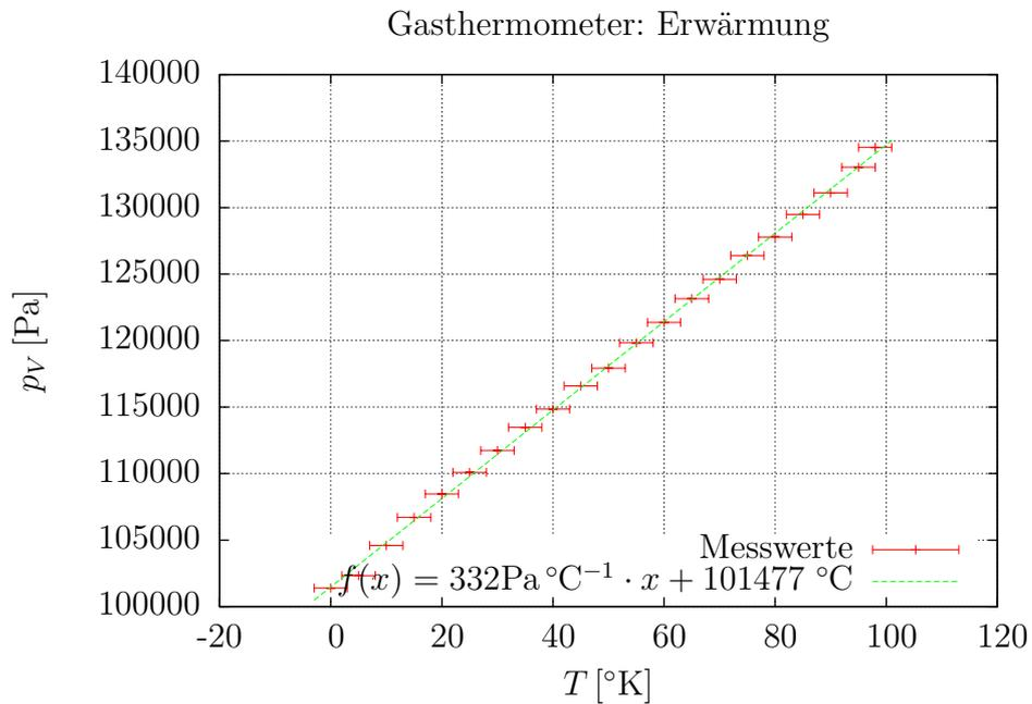
Abbildung 4: Druckmessung während Erwärmung
