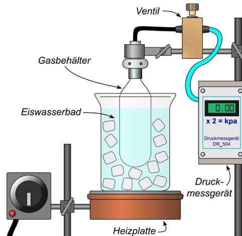
Abbildung 2: Versuchsaufbau: Gasthermometer
