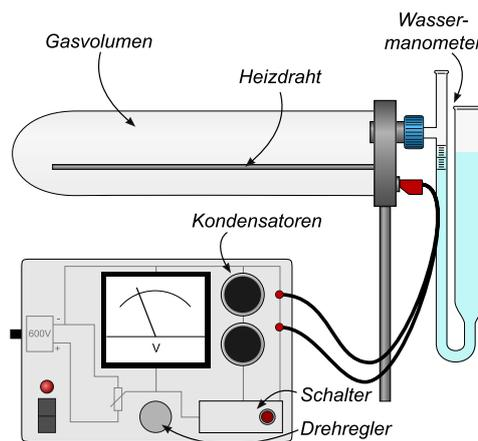
Abbildung 3: Versuchsaufbau: Spezifische Wärme der Luft
