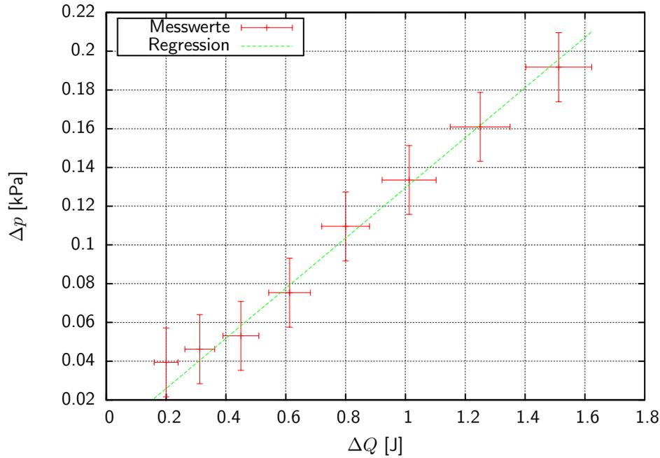
Abbildung 4: Auswertung der Druckänderung abhängig von der elektrischen Energie
