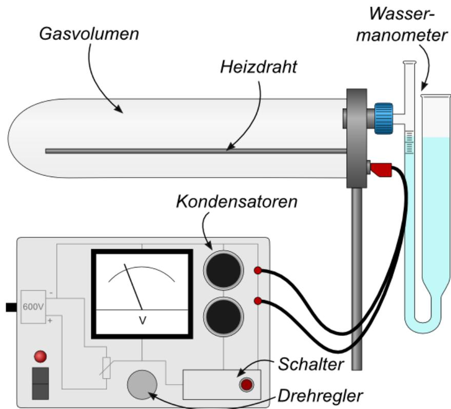
Abbildung 1: Schema des Versuchsaufbaus. Durch Entladung des Kondensators gibt der Heizdraht Wärme an die Luft, die sich erwärmt, wodurch sich der Druck erhöht, und die Differenz am Manometer ablesen werden kann
